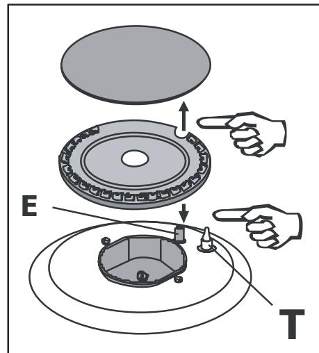
Газовые горелки необходимо промывать соответствующим моющим средством. Необходимо, чтобы после промывания изделие оставалось сухим. Внимательно прочтайте. На модели с электроподжигом электрод «E» всегда должен быть чистым. Вентиляционное отверстие «T» должно быть чистым, чтобы процесс горения был непрерывным. Прежде чем использовать электронную воспламеняющую систему, обратите внимание на то, чтобы изделие было чистым и сухим.
