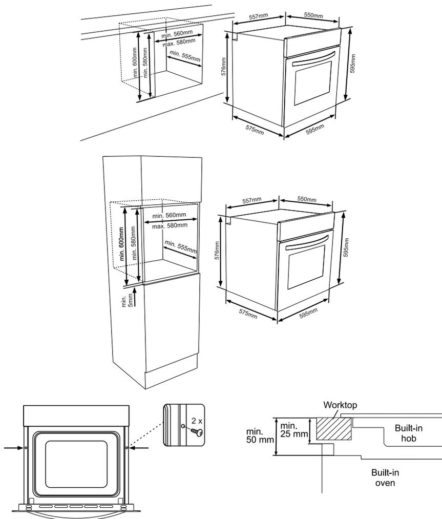
Вставьте духовку в шкаф, продвигая ее от себя. Откройте дверь духовки и вставьте два винта в отверстия, расположенные на раме духовки. Убедившись, что рама продукта соприкасается с деревянной поверхностью шкафа, затяните винты.
