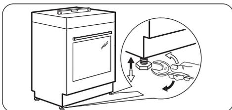
Для выравнивания по высоте верхней части прибора с другими поверхностями используйте маленькие ножки в нижней части прибора.
