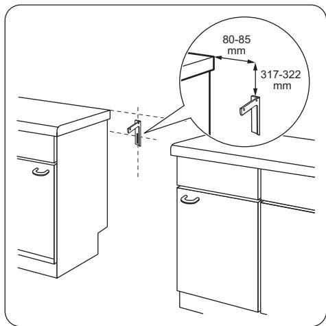
2. Отверстие для крепления находится слева на задней стороне прибора. Поднимите переднюю часть прибора и поместите его между кухонными шкафами. Если расстояние между кухонными шкафами больше, чем ширина прибора, следует установить его так, чтобы зазоры с обеих сторон были одинаковыми.
