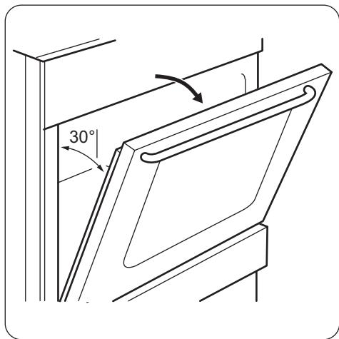
2. Возмитесь за дверную планку (В) на верхней кромке дверцы с обеих сторон и нажмите внутрь, чтобы освободить защелку.
