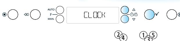
**ВО ВРЕМЯ УСТАНОВКИ ЧАСОВ ДЕРЖИТЕ ДВЕРЦУ ОТКРЫТОЙ.** Это дает возможность произвести настройку часов в течение 5 минут. В противном случае каждый шаг установки должен быть выполнен за 60 секунд.
