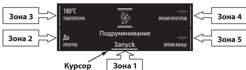
Для перехода между различными областями используйте ручку просмотра/регулировки: курсор перемещается по значениям, которые можно регулировать, как описано ниже. Нажмите кнопку ⏩, чтобы выбрать значение, измените его поворотом ручки просмотра/регулировки и подтвердите нажатием кнопки ⏩.
