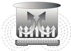
Индукционный нагрев обеспечивается электромагнитным полем. Индукционная катушка внутри плитки, создает электромагнитное поле, которое вызывает нагрев посуды стоящей на поверхности плитки.
