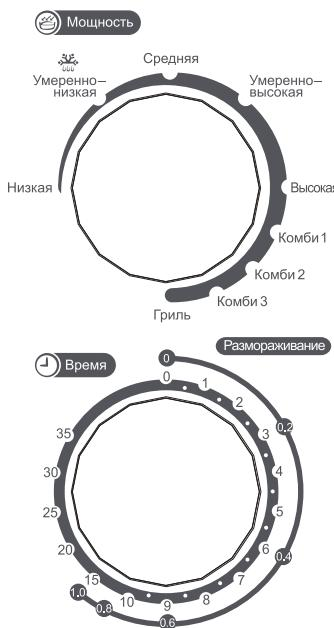
На панели управления расположены регулятор мощности работы микроволновой печи и регулятор времени приготовления/веса размораживаемых продуктов.
