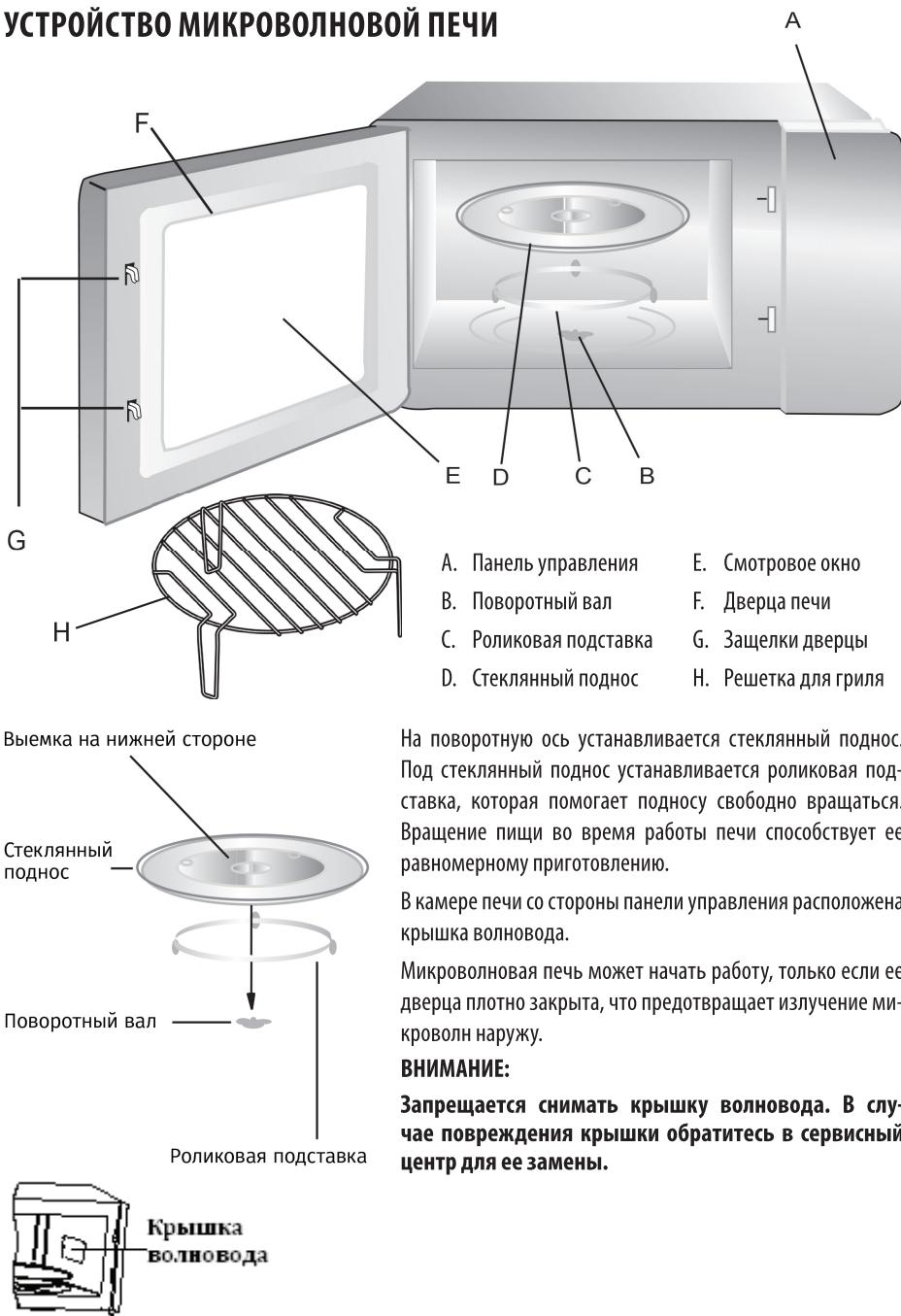
На поворотную ось устанавливается стеклянный поднос. Под стеклянный поднос устанавливается роликовая подставка, которая помогает подносу свободно вращаться. Вращение пищи во время работы печи способствует ее равномерному приготовлению.
