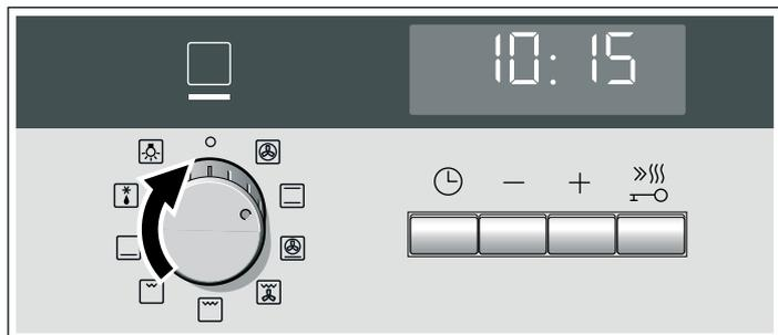
2. Регулятором температуры установите температуру или режим гриля.
