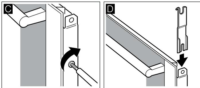
6. Установите защитную панель на место и закрепите её. Если винты защитной панели не вворачиваются, проверьте, правильно ли располагаются стёкла в держателе.
