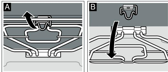
По окончании очистки установите нагревательный элемент гриля обратно в верхнее положение. Откиньте скобу и зафиксируйте нагревательный элемент гриля.
