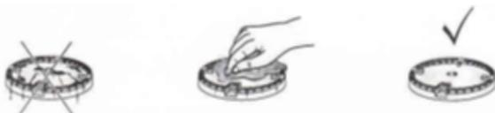
Убедитесь, что корпус головки и зазоры между зубцами чистые и сухие.
