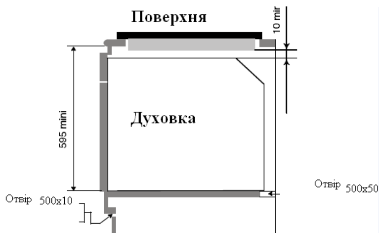
Духовка встановлена під стільницею (Розмір - мм)
