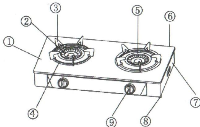
1 - Верхняя панель (в зависимости от модели – из закаленного стекла или нержавеющей стали 0,5мм)
