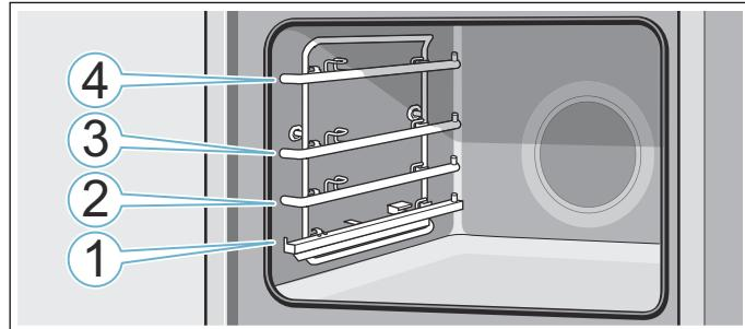
Выдвинутые наполовину принадлежности не опрокидываются. С помощью выдвижных направляющих можно выдвигать принадлежности. Следите за тем, чтобы принадлежности находились под язычком **a** на выдвижной направляющей.
