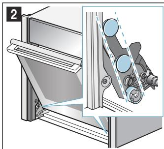
3. Слегка поверните ручку дверцы вверх **a** так, чтобы дверца прибора полностью опустилась вниз **b** (рис. 3).
