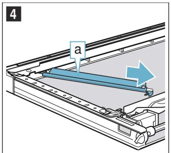
7. Таким же образом снимите второй рефлектор.
