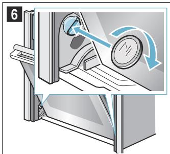
4. Прикройте дверцу, чтобы фиксаторы зафиксировались со слышимым щелчком. Дверца не должна больше закрываться.
