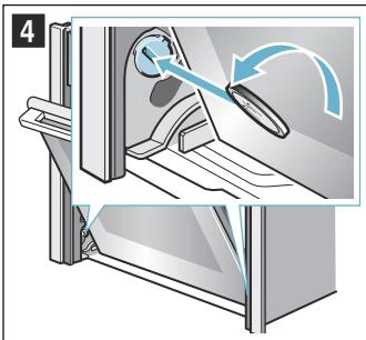
Левый фиксатор: против часовой стрелки
