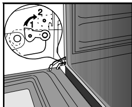
1 Петля дверцы при нормальном использовании
