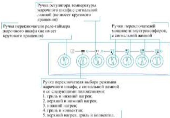
Рис. 8 Передняя панель плиты ЭПС43р4 МС
