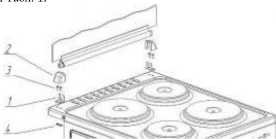
Рис. 6. Установка стеклянной крышки стола.
