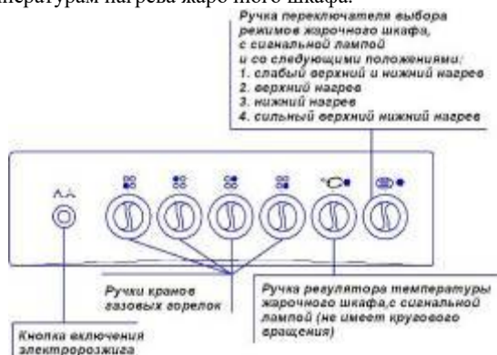
Рис. 11. Передняя панель плит ЭГ401МС-2у; ЭГ401М2С-2у
