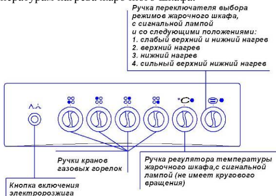
Рис. 11. Передняя панель плит ЭГ401МС-2у; ЭГ401М2С-2у
