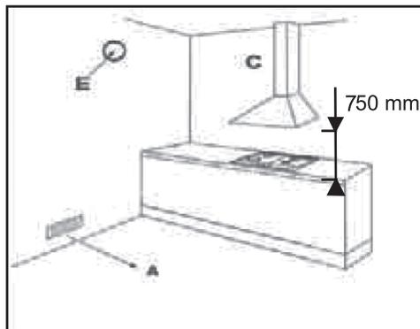
**Примечание:** минимальное расстояние между газовой варочной поверхностью и вытяжкой должно быть не менее 750 мм.
