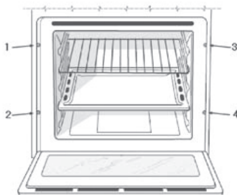
Рис. 9. Крепление духового шкафа к мебели
