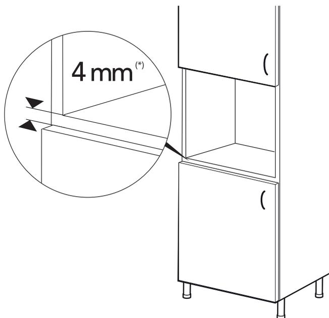
(\*) Если дверца кухонной мебели находится на расстоянии 4 мм от опорной поверхности, установите с нижней стороны прибора входящие в комплект поставки ножки с шайбами толщиной 1 мм.
