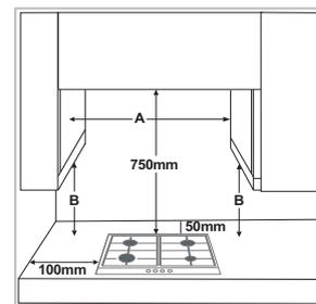
**ПРИМЕЧАНИЕ:** Если расстояние "А" между настенными шкафчиками составляет от 600 мм до 730 мм, то высота "В" должна быть не менее 530 мм. Если расстояние "А" между корпусами настенной мебели больше ширины варочной панели, то высота В должна быть не менее 400 мм. В случае установки вытяжки над варочной панелью необходимо соблюдать размеры, указанные в руководстве для вытяжки.
