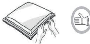
Установите варочную панель в выемку в столешнице, вырезанную по размерам, указанным в Руководстве.
