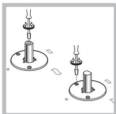
1. Снимите рукоятку и поверните регуляционный винт, расположенный внутри или рядом со стержнем крана, вплоть до получения стабильного малого пламени:
