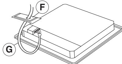
**Прибор должен подключаться к электросети через многополюсный выключатель с расстоянием между контактами не менее 3 мм.**
