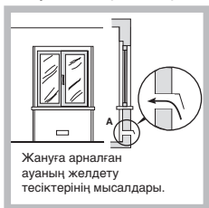
Жапсарлас бөлме Желдетілетін бөлме Терезе мен еден арасындағы желдету санқылауын кеңейту.
