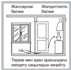
Жануға арналған ауаның желдету тесіктерінің мысалдары.
