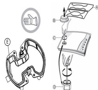
Прежде чем устанавливать варочную панель, не забудьте прикрепить прилагаемую к инжекторам табличку с данными, касающимися нового типа газа, таким образом, чтобы она закрыла собой табличку, относящуюся к предыдущему типу газа.
