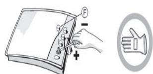
Такая регулировка должна выполняться, когда кран находится в положении, соответствующем минимальной подаче газа (слабое пламя) Ø.
