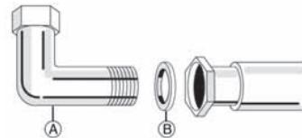
После подключения к системе подачи газа проверьте отсутствие утечек газа, пользуясь мыльным раствором.
