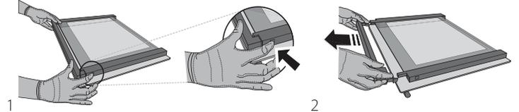
Поднимите внутреннее стекло, крепко удерживая его обеими руками, затем снимите и перед очисткой положите его на мягкую поверхность (3).
