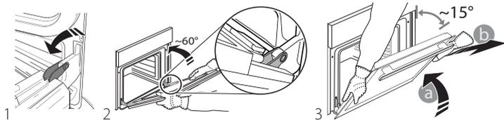
Положите дверцу на мягкую поверхность. Для установки дверцы поднесите ее к духовке, совместите крючки петель с гнездами и вставьте верхние части петель в гнезда. Опустите дверцу, а затем полностью откройте ее. Поверните фиксаторы в исходное
