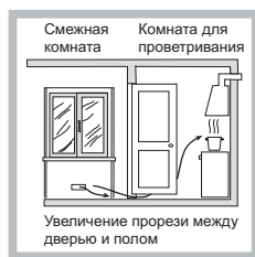
Примеры вентиляционных отверстий для воздуха горения
