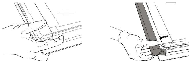
**3.** Внутреннее стекло установлено правильно, если в левом углу видна буква "R", а прозрачная поверхность (без принта) смотрит вверх. Сначала вставьте в пазы (a) длинную сторону стекла с буквой "R", затем опустите его в положение (b).
