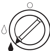
Кран работает в режиме «малое пламя»
