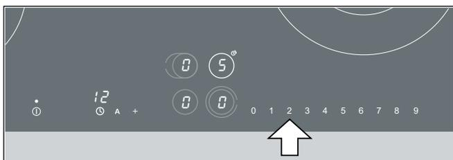
По истечении заданного времени конфорка выключается. На индикаторе ступени нагрева мигает 5. В течение трёх минут звучит звуковой сигнал. На индикаторе таймера мигает 00. Прикоснитесь к любой сенсорной клавише. Индикации гаснут, а звуковой сигнал выключается.
