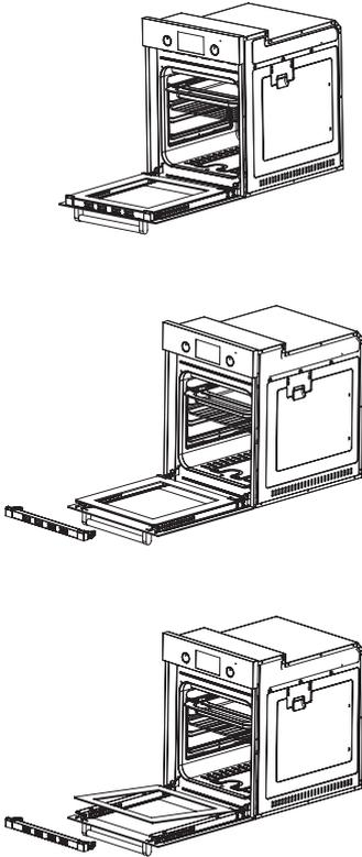
Нажмите на пластиковые защелки по левой и правой стороне дверцы, как показано на рис. 6. Потяните планку на себя и снимите ее. После снятия планки, внутреннее стекло останется свободным. Снимите и помойте его.
