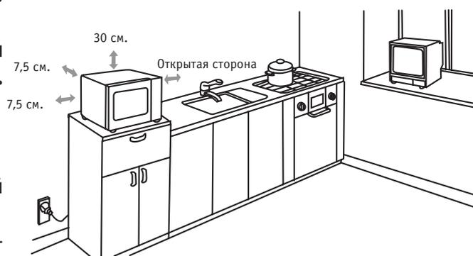
**ПРЕДОСТЕРЕЖЕНИЕ:** Не устанавливайте печь над плитой или другими тепловыми электроприборами, иначе это может вызвать повреждение печи и аннулирование гарантии.
