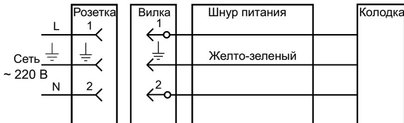
При подсоединении плиты к электрической сети питания должны применяться вилка и розетка, рассчитанные на ток не менее 1 А и напряжение 250 В.
