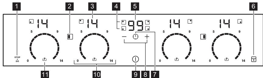
Для подсветки панели управления включите прибор при помощи ①.
