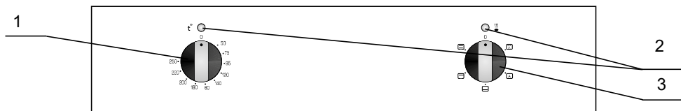
рис.9. Панель электрошкафа без таймера
