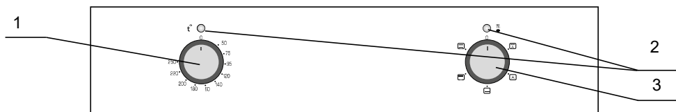
рис.7. Панель электрошкафа без таймера
