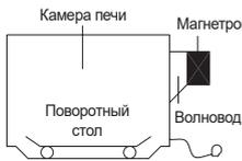
В микроволновой печи электричество преобразуется в микроволны МАГНЕТРОНОМ.
