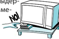
**У**станавливайте печь на достаточном расстоянии от источников тепловыделения. Для обеспечения достаточной циркуляции воздуха над печью следует оставить пространство не менее 30 см. Под днищем, сверху и по сторонам печи не должно быть препятствий для обеспечения достаточной циркуляции воздуха. Микроволновую печь не следует устанавливать в шкафу. Микроволновую печь не следует устанавливать на рабочую поверхность выше 850 мм от пола.
