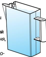
**Необходимо обязательно опорожнять емкость для воды после каждого использования. Это важно с точки зрения санитарно-гигиенических требований. Кроме того, опорожнение этой емкости помогает предотвращать накопление конденсата внутри печи.**
