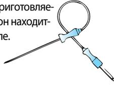
Необходимо как можно глубже вставить щуп в продукт на его максимальную длину. Это обеспечит более точные показания температуры.
