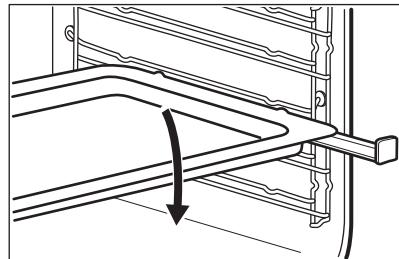
**Одновременная установка решетки и противня для жарки:**
