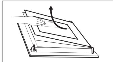
9. Вымойте стеклянную панель водой с мылом. Тщательно вытряните стеклянную панель.
