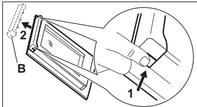
7. Чтобы снять дверную планку, потяните ее вперед.
