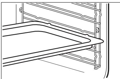
Одновременная установка решетки и глубокого противня:
