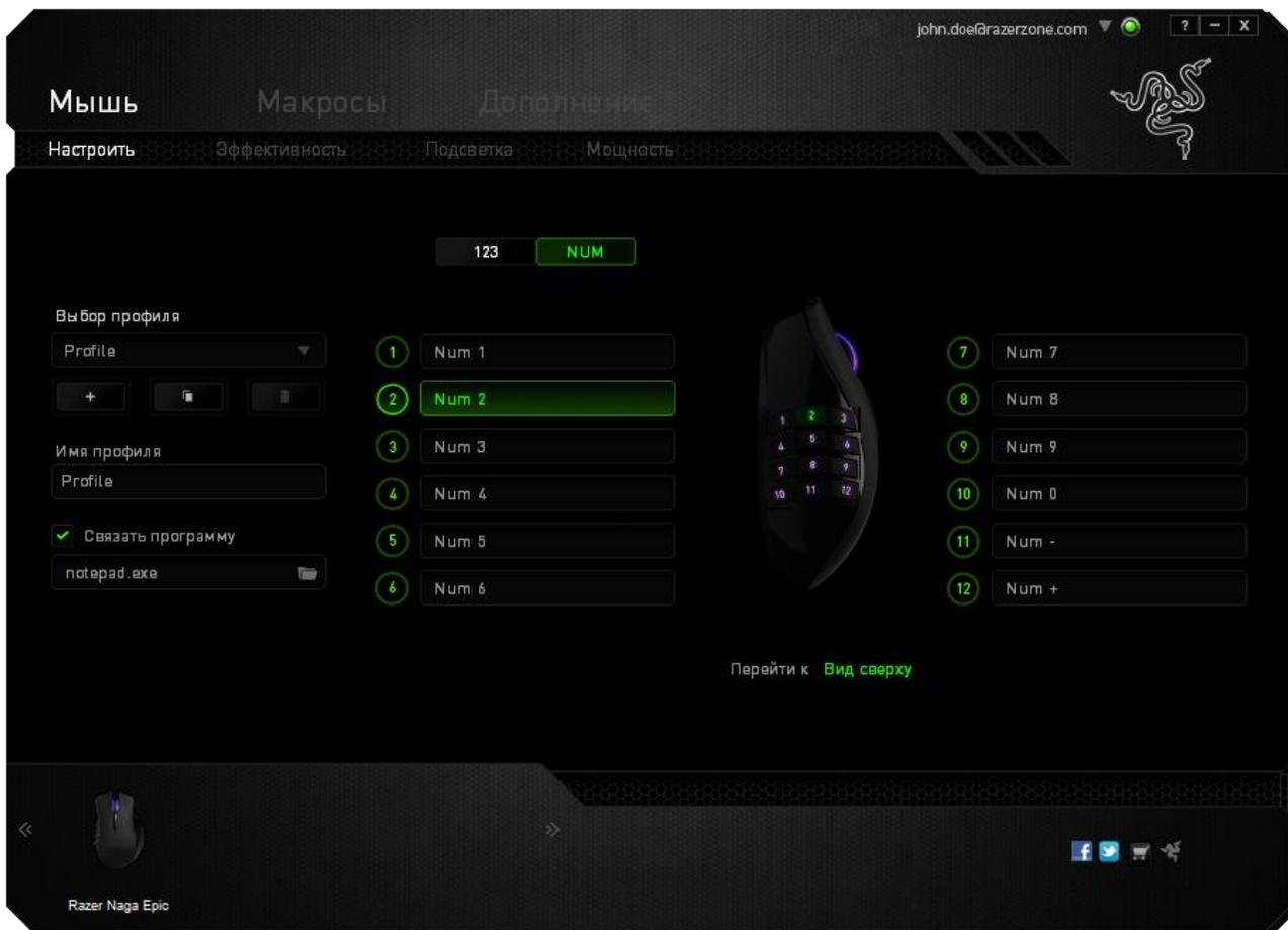
Можно настроить оба режима (основной [123] и дополнительный [Num]) с помощью переключателя в середине экрана. Настройка панели для большого пальца в любом из режимов не требует использования переключателя в нижней части Razer Naga Epic. Однако этот переключатель необходим для переключения между основной [123] и дополнительной [Num] конфигурацией.
