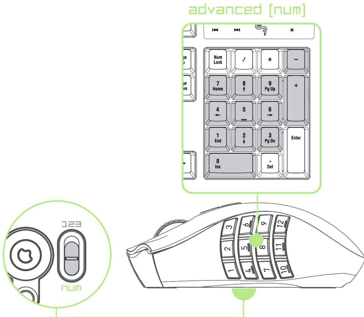
В дополнительном [Num] режиме панель для большого пальца используется в качестве цифровой панели клавиатуры. Эти кнопки обеспечивают более быстрый доступ к игровым командам без использования цифровой панели.
