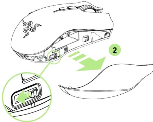
3. Переместите переключатель замка блокировки и вставьте батарею в батарейный отсек. (Чтобы извлечь батарею, снова переместите переключатель замка блокировки).
