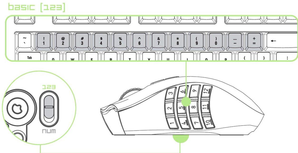
В основном [123] режиме 12-кнопочная панель для большого пальца выполняет те же функции, что и цифровая панель клавиатуры. Эти кнопки позволяют дублировать на панели для большого пальца функции панели действий большинства игр.
