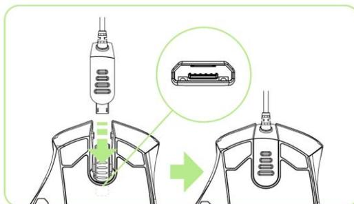
3. Подключите мышь к USB-порту компьютера. Теперь мышь Razer Naga Epic готова к работе в высокопроизводительном проводном режиме. Кроме того, в этом режиме выполняется автоматическая зарядка батареи мыши.
