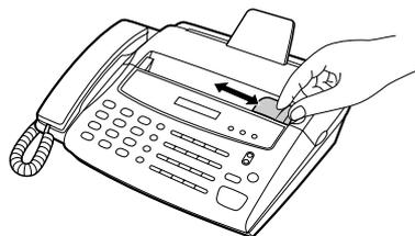
Отрегулируйте направляющую, расположенную на подающем устройстве справа, по ширине Вашего документа.
