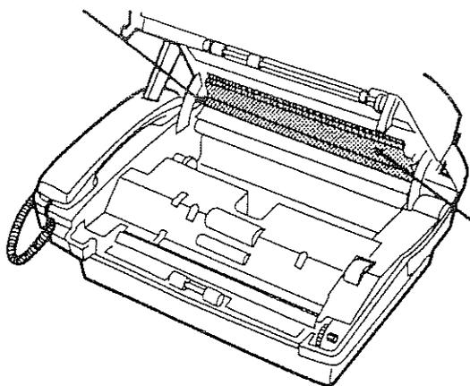
Протирайте печатающую головку и края ее защитной крышки мягкой тканью, смоченной в изопропиловом спирте.
