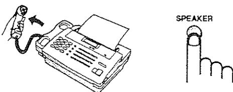
Поднимите трубку или нажмите на кнопку **SPEAKER**. Вы услышите сигнал незанятой линии.
