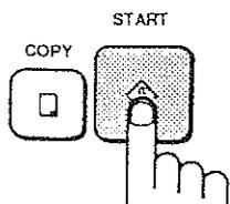
Услышав звуковой сигнал факса, нажмите на кнопку **START**. Опустите телефонную трубку.
