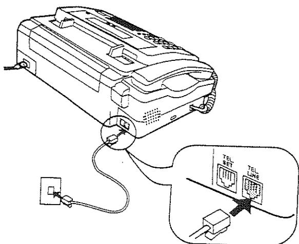
Соедините один конец провода с гнездом на задней панели аппарата, обозначенным **TEL. LINE**. Другой конец провода подключите к телефонной розетке.
