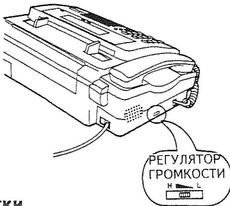
При помощи этого переключателя регулируется громкость звука в трубке и сигнала вызова. Вы можете перемещать его по желанию от значения "громко" (H) до значения "тихо" (L).
