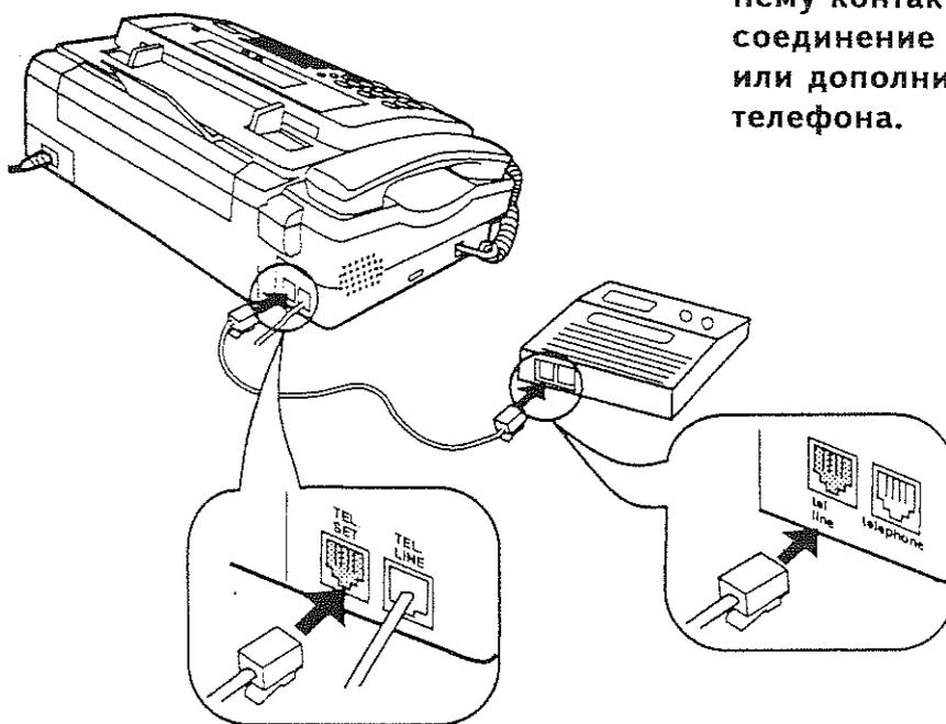
**Внимание:** При подключении автоответчика убедитесь в том, что провод подключен к гнезду телефонной **линии** на его панели, а не к гнезду телефона.
