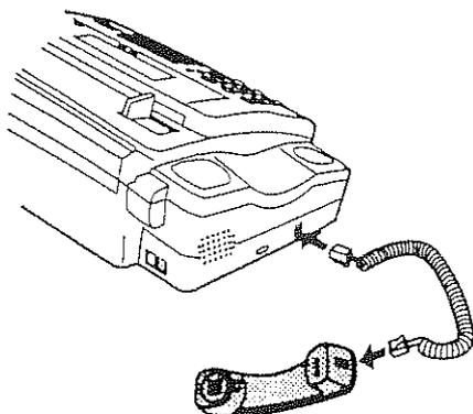
Соедините шнур с трубкой и аппаратом, как это указано на рисунке.
