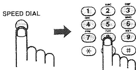
Нажмите на кнопку **SPEED DIAL** и затем при помощи цифровых кнопок введите код номера Ускоренного Набора, состоящий из 2-х цифр.
