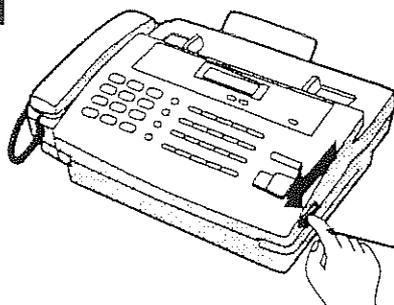
Стопорный рычажок, находящийся на корпусе факса справа, сдвиньте вперед и откройте крышку.
