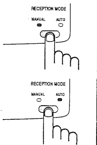
Режим приема устанавливается при помощи кнопки **RECEPTION MODE**, расположенной на панели управления.
