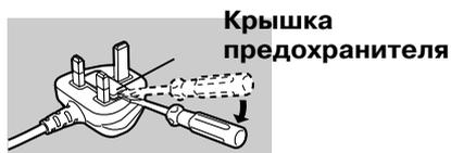
2) Замените предохранитель и установите на место крышку предохранителя.
