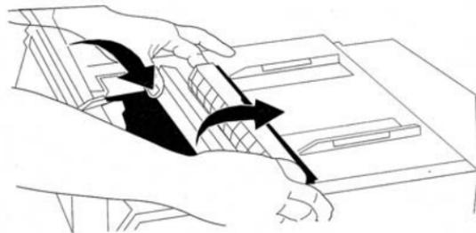
4. Установите на место узел подтяжки бумаги и закройте крышку доступа.
