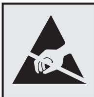
Этим знаком обозначаются компоненты, чувствительные к статическому электричеству. Перед тем, как прикоснуться к поверхностям, отмеченным такими знаками, необходимо дотронуться до металлического корпуса принтера.
