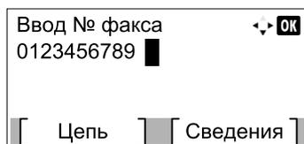
В номере принимающего аппарата может содержаться до 64 цифр.
