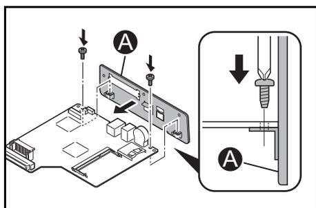
**7** Установите пластину, поставляемую с дополнительным оборудованием, и закрепите ее 2 винтами.
