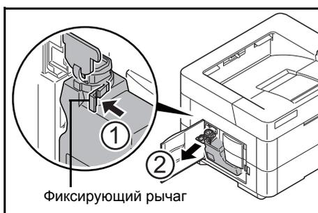
**2** Придерживая бункер отработанного тонера, нажмите на фиксирующий рычаг, затем аккуратно извлеките бункер отработанного тонера.
