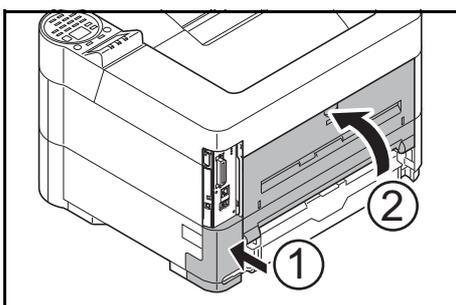
**12** Установите на место крышку и закройте заднюю крышку.
