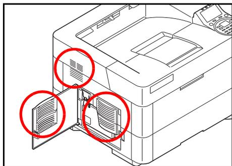
**6** Откройте левую крышку. Тканью без ворса очистите вентиляционные отверстия от пыли и грязи.
