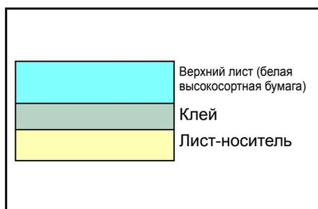
Бумага этикетки имеет структуру, состоящую из трех слоев, как показано на схеме. Верхний лист печатается. Клейкий слой состоит из чувствительного к давлению клейкого вещества. Лист-носитель (его также называют линейным или подкладочным листом) удерживает этикетки до использования. Из-за сложности своего состава этикеточная бумага с клееной подкладкой наиболее подвержена проблемам при печати.
