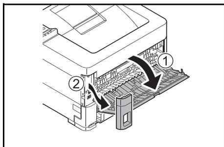
**2** Откройте заднюю крышку и снимите крышку интерфейсных разъемов.
