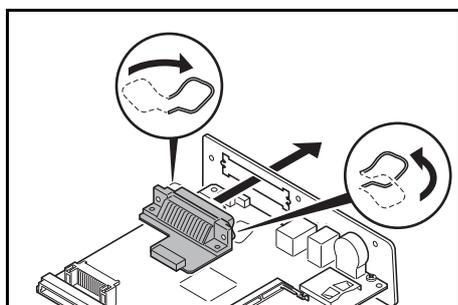
**8** Прикрепите Комплект параллельного интерфейса к пластине.
