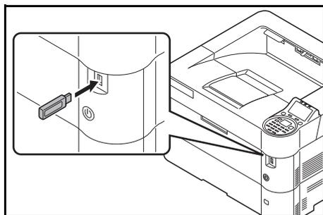
Память USB — это разновидность простого в использовании и удобного при переноске запоминающего устройства, которое подключается в разъем для памяти USB. Сохраненные в памяти USB файлы можно вывести на печать, вставив запоминающее USB-устройство в соответствующий порт принтера и затем выбрав с помощью панели управления имена файлов для печати.
