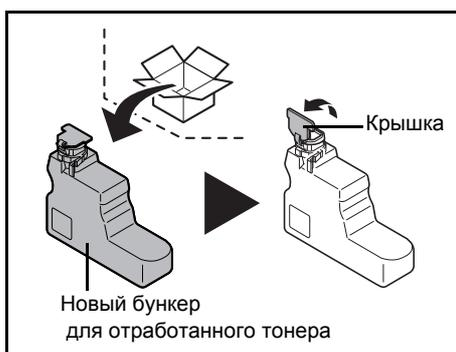
**5** Откройте откидную крышку нового бункера для отработанного тонера.
