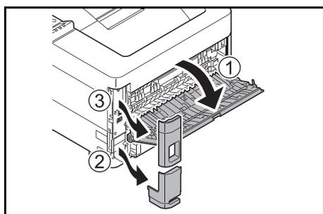
**2** Откройте заднюю крышку и снимите крышку интерфейсных разъемов и крышку разъема для шнура питания.
