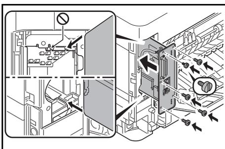
**11** По завершении установки дополнительного оборудования установите на место плату главного контроллера и закрепите ее винтами.
