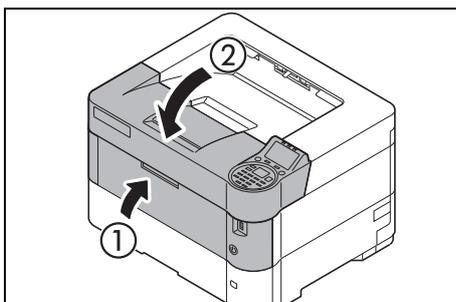
**5** Закройте верхнюю крышку и переднюю крышку. Принтер прогреется и возобновит печать.
