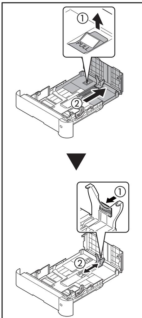
Если вы собираетесь использовать бумагу длиннее, чем A4-R, извлекайте кассету до ее контакта с упором в задней части кассеты, после чего отрегулируйте направляющую длины бумаги в соответствии с выбранным форматом бумаги.
