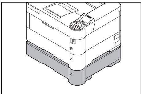
Дополнительный податчик бумаги PF-4100 рассчитан приблизительно на 500 листов бумаги. В нижней части принтера можно установить до 4 дополнительных податчиков, обеспечив таким образом непрерывную подачу до 2500 листов бумаги при их использовании в сочетании с собственной кассетой принтера.
