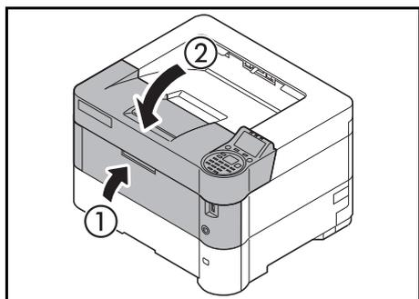
**5** Закройте верхнюю крышку и переднюю крышку.
