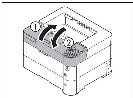
**4** Чтобы сбросить состояние ошибки, откройте и закройте верхнюю крышку.
