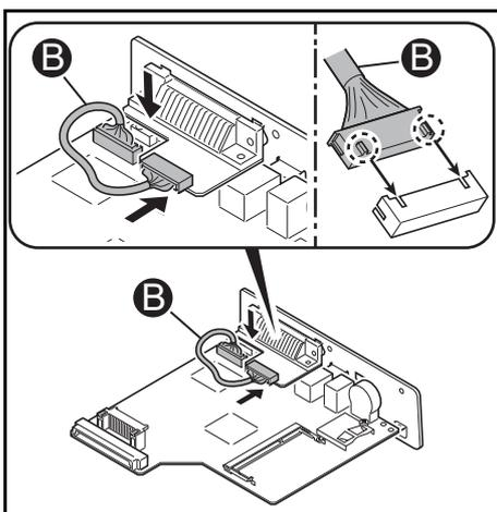
**10** Присоедините соединительный элемент комплекта Комплект параллельного интерфейса к соединительному элементу платы главного контроллера.
