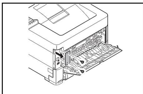
**3** Вывинтите два винта и снимите крышку.
