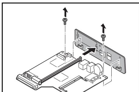
**5** Вывинтите два винта и снимите пластину.
