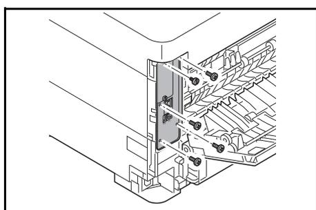
**3** Вывинтите пять винтов на задней части платы главного контроллера.
