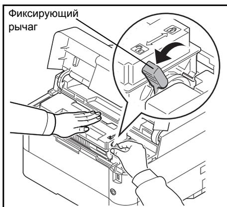
**2** Поверните фиксирующий рычаг в положение разблокировки.
